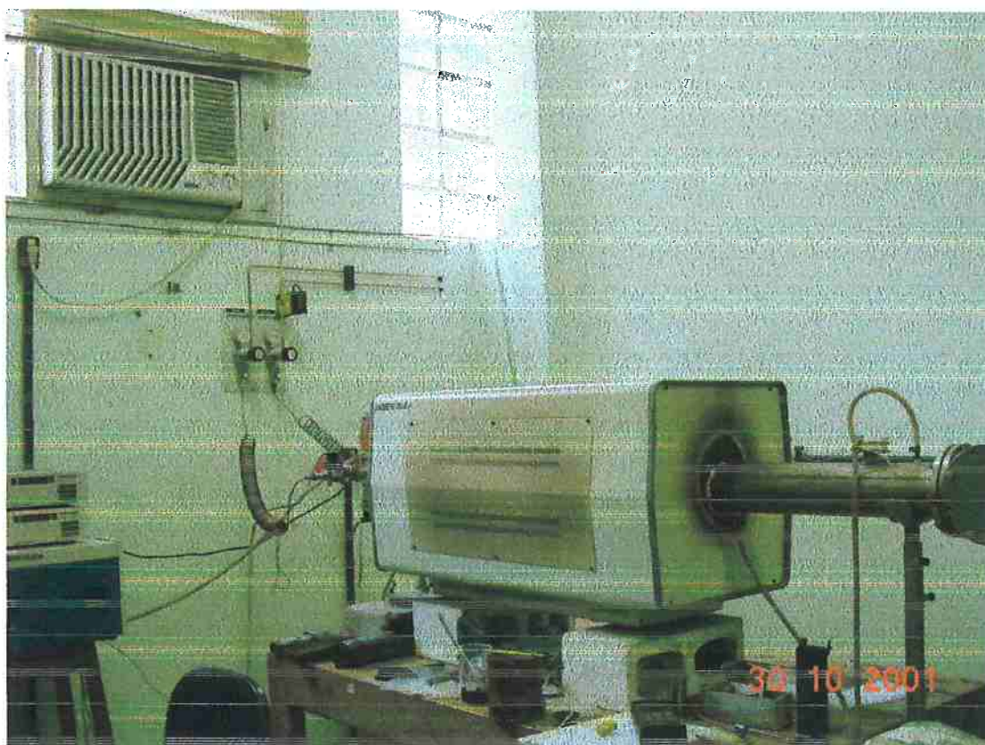
Figura 3.2-4 - Fotografia do forno resistivo de atmosfera controlada – FR-01 [11]
